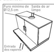
**EXAUSTOR** - O sistema de exaustão suga os vapores do cozimento filtrando e lançando para o ambiente externo através de um tubo sanfonado instalado, ligando o aparelho a área externa.
