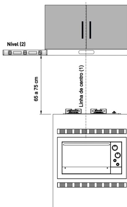
Para a fixação do depurador, retire os filtros de alumínio e marque no móvel, com o auxílio do depurador, o local para a furação. Utilizando o kit de fixação (parafusos e arruelas), fixe o depurador no móvel. Os parafusos são auto atarraxantes e podem ser fixados com ajuda de uma parafusadeira ou chave Philips.
