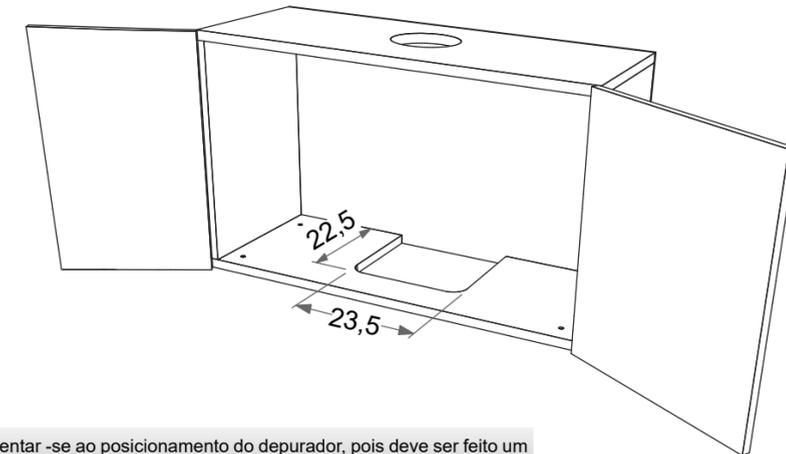
NOTA: Atentar -se ao posicionamento do depurador, pois deve ser feito um recorte no móvel de 23,5 cm x 22,5 cm para o encaixe da caixa do motor.
