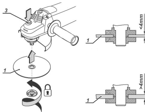
Figura 5 – Montaje del disco en la máquina
