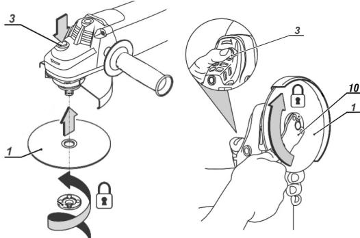
Figura 8 – Trocando o disco / Finalizando a substituição
