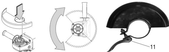
Figura 3 – Montagem e posicionamento da capa de proteção
