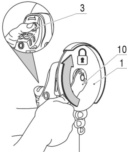
Figura 6 – Montagem do disco na máquina
