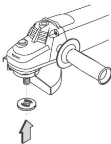
Figura 4 – Montagem de acessórios na máquina
