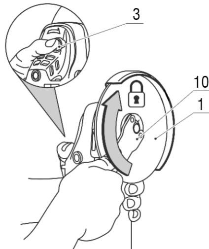
Figura 6 – Montaje del disco en la máquina
