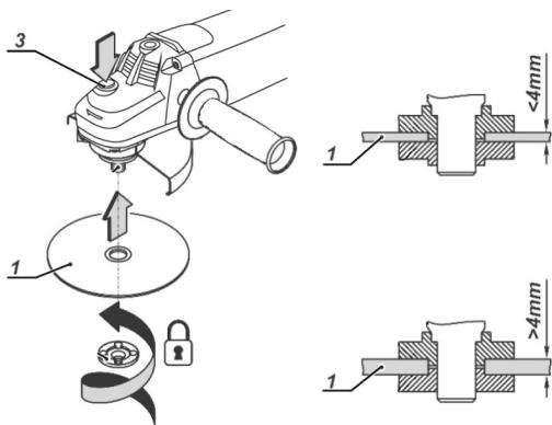
Figura 5 – Montagem do disco na máquina
