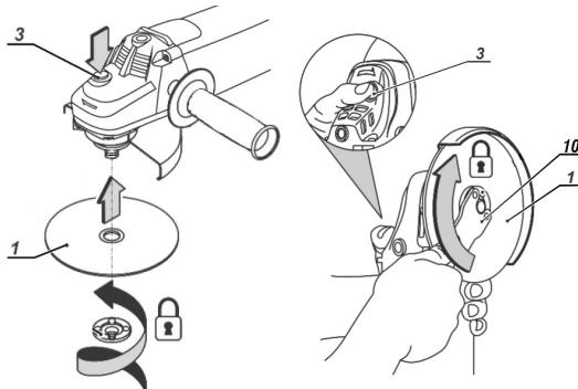
Figura 8 – Cambio del disco/ Finalización de la sustitución
