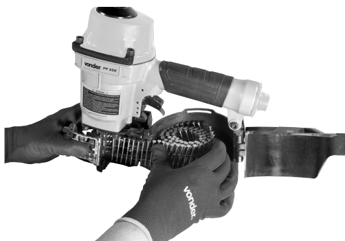
Figura 4 – Abastecimiento de los clavos
